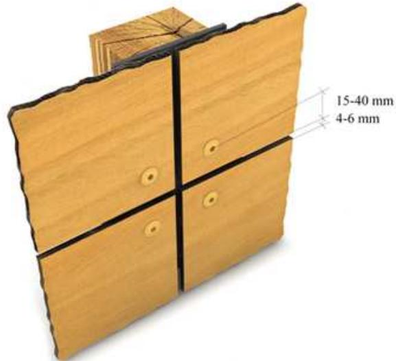
Los tornillos y los remaches\* de las esquinas del panel deben estar entre 15 y 40 mm del borde del panel.
